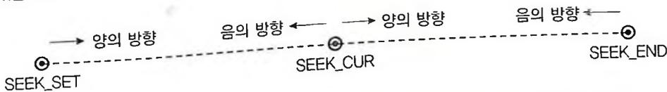
위의 그림에서와 같이 파일의 처음으로 이동하려면 `fseek(fp, 0L, SEEK_SET);`을 사용하며, 파일의 끝으로 이동하려는 경우는 `fseek(fp, 0L, SEEK_END);`를 사용합니다. 만약, 파일의 처음으로부터 100바이트 만큼의 위치로 이동하려면, `fseek(fp, 100L, SEEK_SET);`처럼 사용하면 되겠지요.
